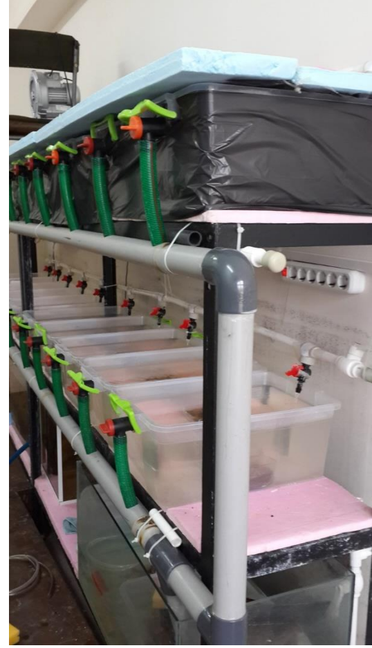
Şekil 3. İki farklı fotoperiyot uygulaması kullanılan deneme sisteminin genel görüntüsü (üstteki sistemde 24 saat karanlık, alttaki sistemde 12 saat aydınlık/12 saat karanlık fotoperiyot uygulanmıştır).
